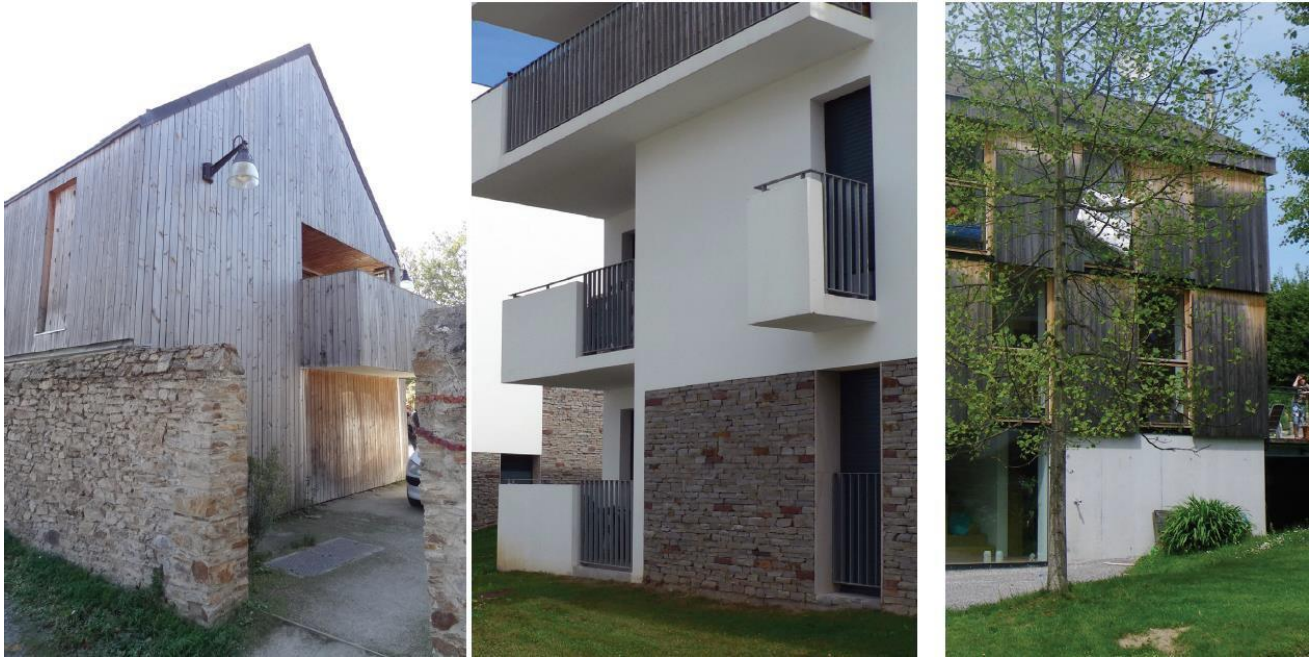
Exemples de traitements de soubassements marquant la spécificité du « socle » en lien avec le terrain naturel
